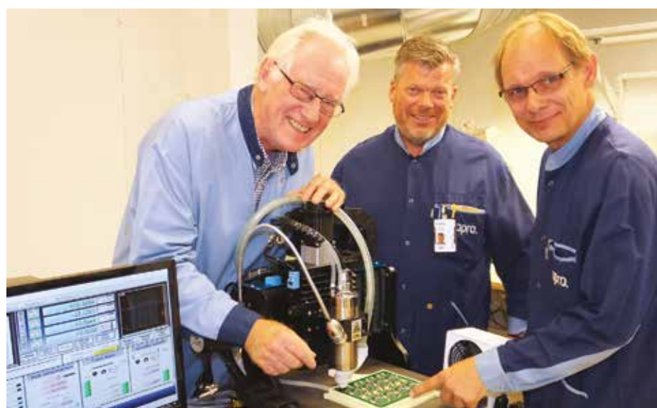
Fresende godt samarbeid: F.v. Helge Nilsen (Elprint/Macaos), Steinar Hagaseth (Hapro) og Per Gunnar Løvhaug (Hapro) har drevet intensiv uttesting av den nye depaneleringsmaskinen, som henter produksjonsdata direkte fra mønsterkortprogrammet Macaos. – Dette kan forenkle hverdagen vår, og gjøre ting raskere, mener Løvhaug.
